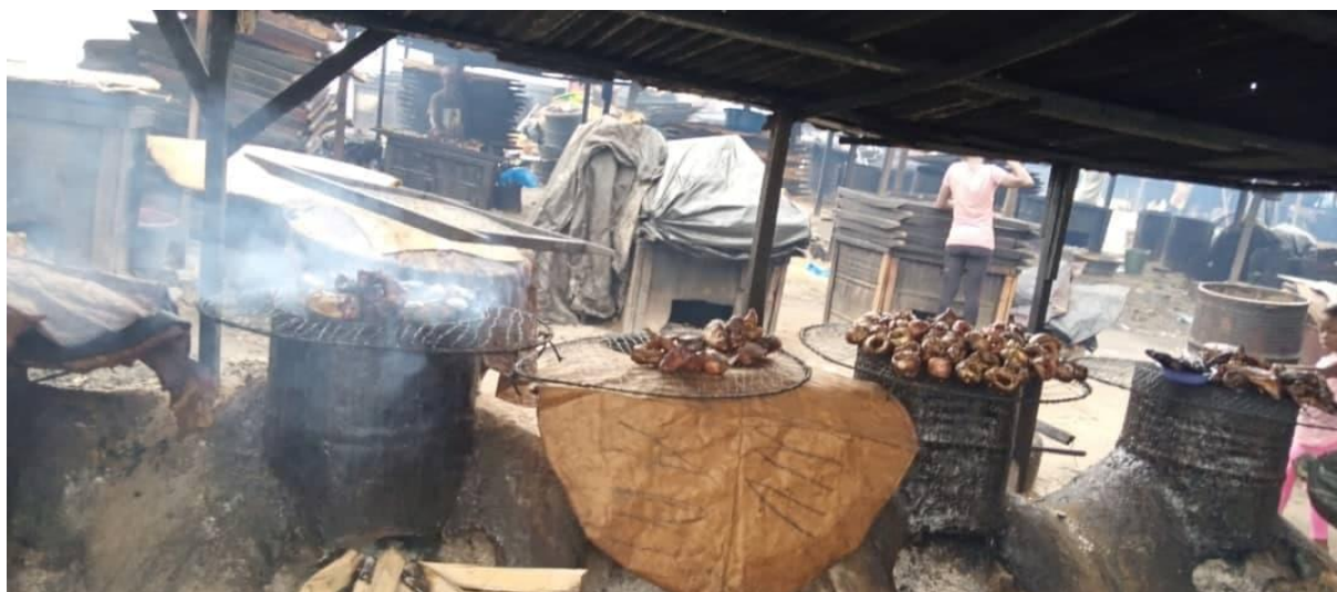
Photo 1 : Fours traditionnels fabriqués à partir de barils industriels sur un site de fumage à Abobo-Doumé, dans la commune d'Attécoubé à Abidjan
