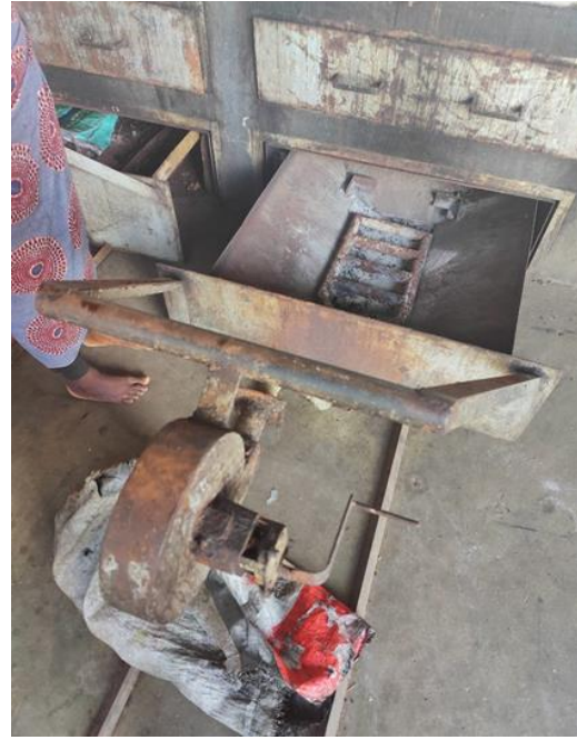
Photo 16 : Système manuel de ventilation du feu et autres éléments du four rouillés (Jossinet, 2022)
